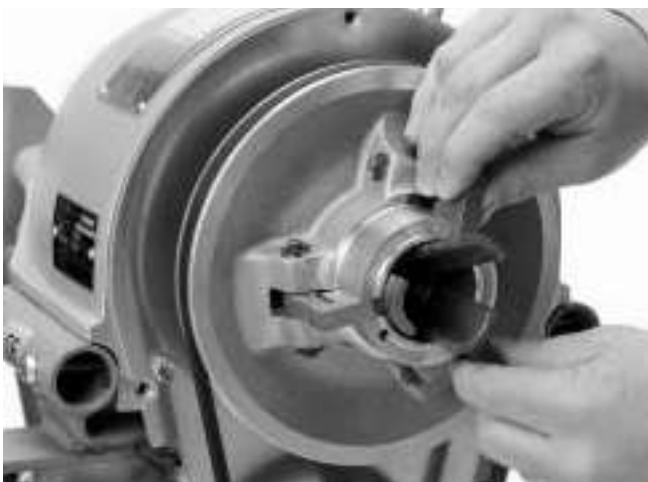
Figura 12 – Recambio de las mordazas del embrague
