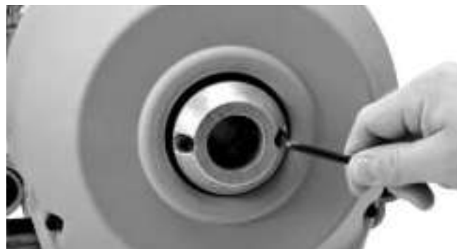
Figura 11 – Recambio de las mordazas del embrague
