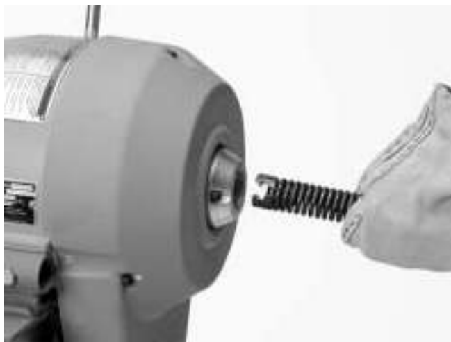
Figura 3 – Introducción del cable por la parte delantera de la máquina
