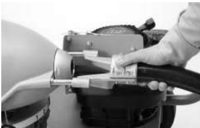
Figura 2 – Acoplamiento de la manguera guía trasera
