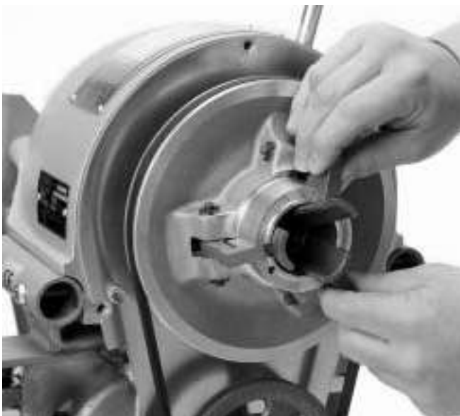
Figure 12 – Remplacement des mâchoires d'embrayage
