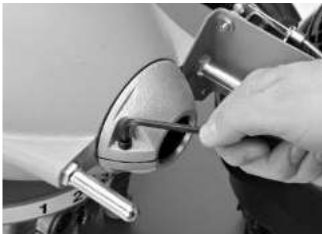
Figure 13 – Elimination du jeu axial de l'embrayage
