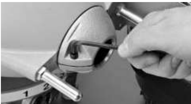
Figura 13 – Eliminación del juego (holgura) del embrague
