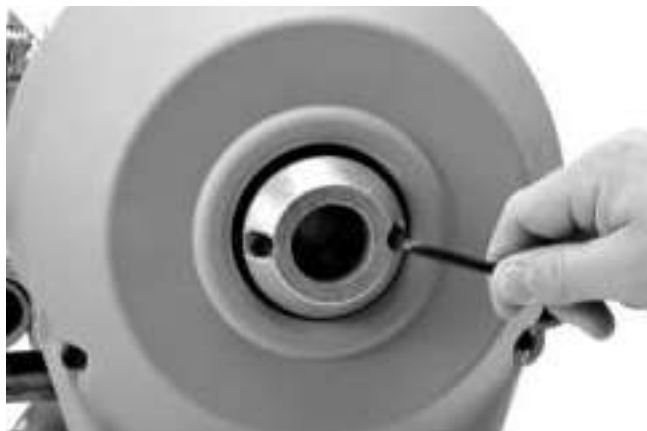
Figure 11 – Remplacement des mâchoires d'embrayage
