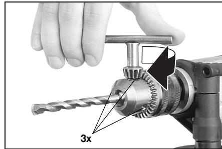
**Fixar a ferramenta:** Colocar a ferramenta e apertar uniformemente nos 3 orifícios, mediante uma chave da bucha.
