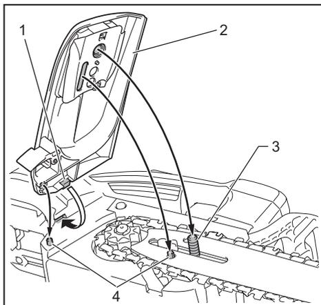
► 1. Protrusion 2. Sprocket cover 3. Bolt 4. Pin
