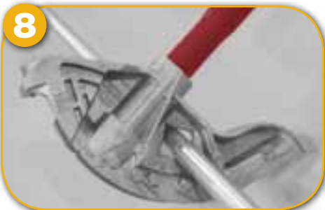
Vise-Mate Eleva y afirma el tubo mientras se corta o ensancha
