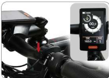
A continuación, pulse la tecla de encendido del instrumento para iniciar el sistema ebike
