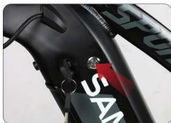
Appuyez sur le bouton d'alimentation et l'interrupteur s'allume après la mise sous tension.
