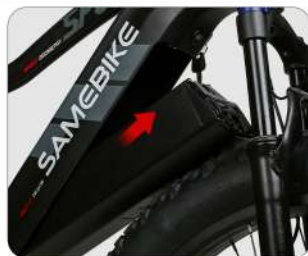
Entfernen Sie die Batterie nach oben
