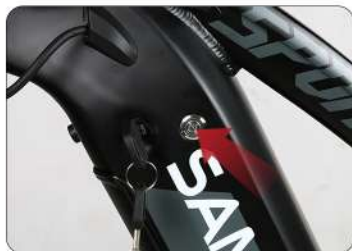
Pulsa el botón de encendido y el interruptor se encenderá tras el encendido.
