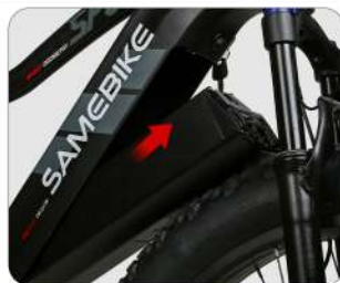
Retire la batería hacia arriba
