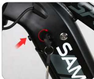
Gire la llave en el sentido de las agujas del reloj para desbloquear el bloqueo de la batería y, a continuación, pulse el botón.
