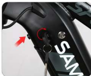
Tournez la clé dans le sens des aiguilles d'une montre pour déverrouiller le verrou de la batterie, puis appuyez sur le bouton.
