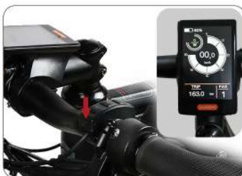
Appuyez ensuite sur la touche d'alimentation de l'instrument pour démarrer le système ebike.
