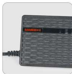
La luz roja indica que la batería se está cargando, la verde que está llena
