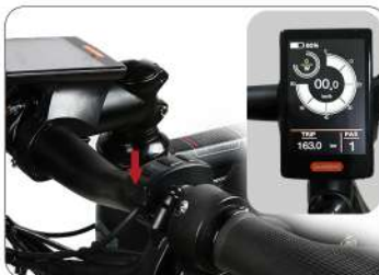
Drücken Sie dann die Power-Taste des Instruments, um das E-Bike-System zu starten.
