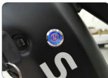
Veuillez éteindre le bouton d'alimentation après avoir roulé. Il est normal que l'alimentation prenne quelques secondes pour éteindre la lumière.
