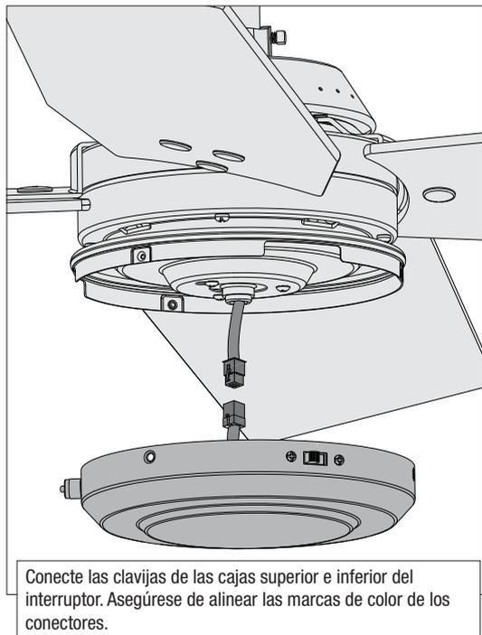
Conecte las clavijas de las cajas superior e inferior del interruptor. Asegúrese de alinear las marcas de color de los conectores.
