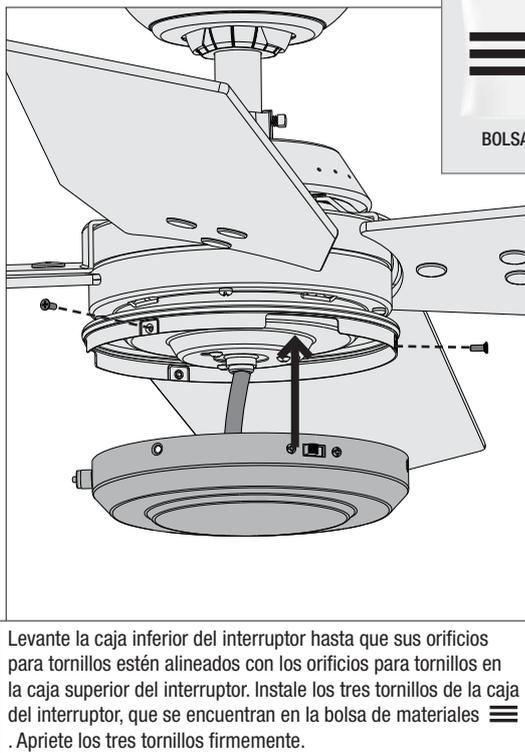
Levante la caja inferior del interruptor hasta que sus orificios para tornillos estén alineados con los orificios para tornillos en la caja superior del interruptor. Instale los tres tornillos de la caja del interruptor, que se encuentran en la bolsa de materiales
