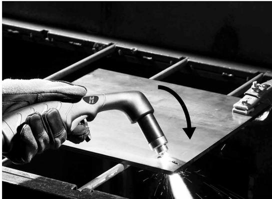
**4.** Sostener la antorcha en esta posición sin dejar de oprimir el gatillo. Cuando las chispas salgan por debajo de la pieza a cortar el arco perforó el material.
