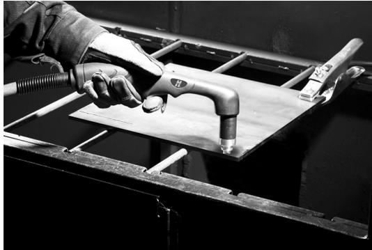
2. Oprimir el gatillo de la antorcha para arrancar el arco. Quedarse en el borde hasta que el arco penetre del todo la pieza a cortar.
