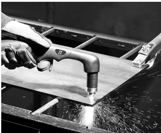
**5.** Al terminar la perforación, arrastre la punta de la antorcha ligeramente a lo largo de la pieza a cortar para proseguir el corte.
