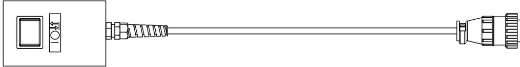
El control de arranque remoto le permite encender y detener la antorcha mecanizada en forma remota. Por ejemplo, utilícelo cuando monte la antorcha en un quemador de riel simple o guía de corte que no tenga su propio Control Numérico por Computadora u otro tipo de controlador.
