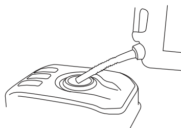
Figura 10 – Agregado de combustible
