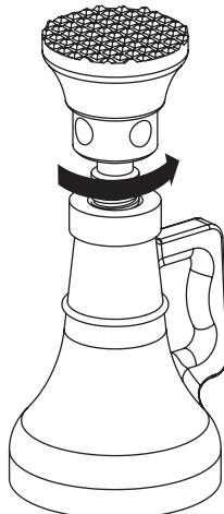
5. Gire la barra de acero con manivela en sentido anti horario para levantar el soporte de elevación hasta alcanzar la altura deseada.
