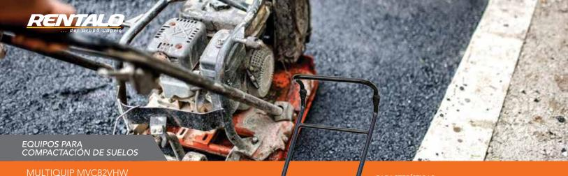
COMPACTADOR DE PLACA POR VIBRACIÓN HONDA GX-160
